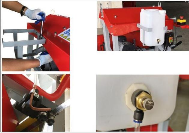
5. Ensamble el tanque de lubricante.
