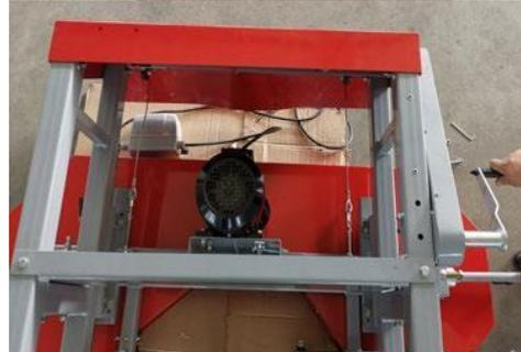
4. Coloque el aserradero sobre el sistema de rieles: Entre al menos dos personas, coloque el aserradero en el sistema de rieles y asegúrese que las ruedas del vagón descansan sobre los rieles. El poste cuadrado vertical debe quedar del mismo lado que el soporte para leños.
