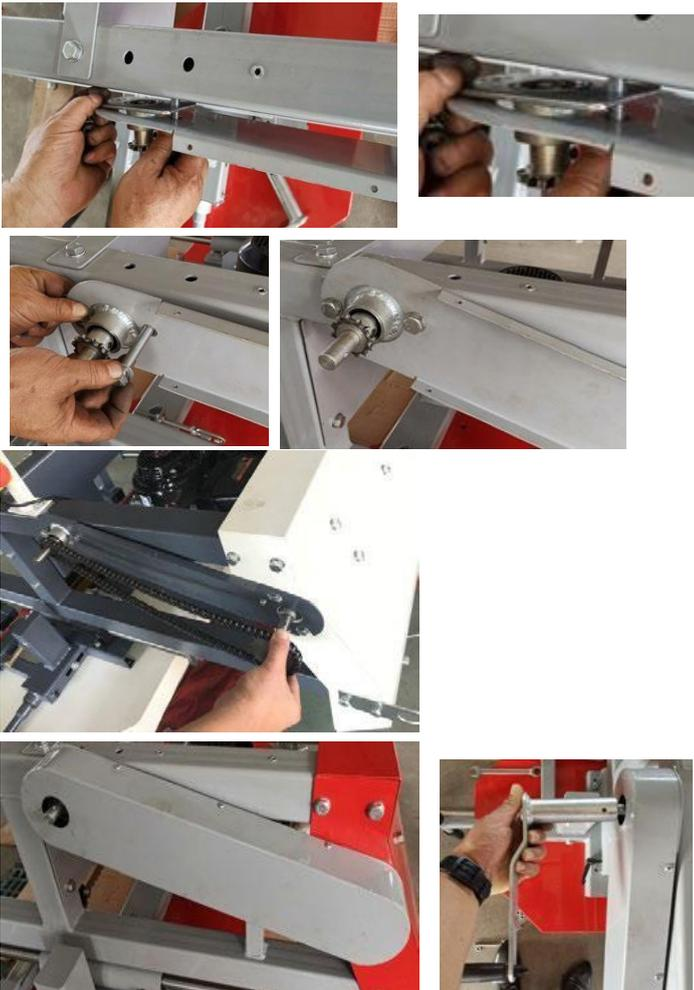
3.6 Ensamblaje de cadena para subir y bajar la herramienta: Fije la rueda dentada y la placa para la transmisión con cadena al marco derecho con tornillos, arandelas y tuercas. Fije la placa para la transmisión con cadena con tornillos a la parte superior de la carcasa.
