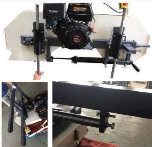
3.1 Colocar la cabecera de la herramienta en el soporte: Levantar la cabecera fuera del paquete de entrega y colocarlo en una superficie limpia y estable.
