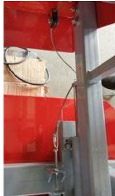
3.7 Conecte los cables para el mecanismo de subir o bajar: Conecte ambos extremos del cable de acero al mango en la cabecera de la herramienta y gire el mango de la cadena para tensionar el cable de acero.
