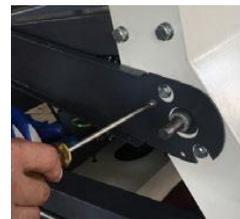
Fije la cadena a la rueda dentada inferior y fije la rueda en la parte superior del eje.
