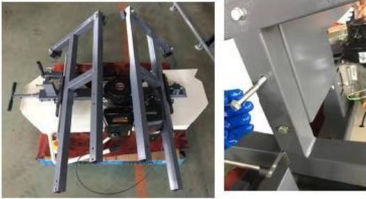
3.4 Ensamblaje de placa del medio: Fije la placa del medio con tornillo, arandelas y tuercas en los marcos izquierdo y derecho.
