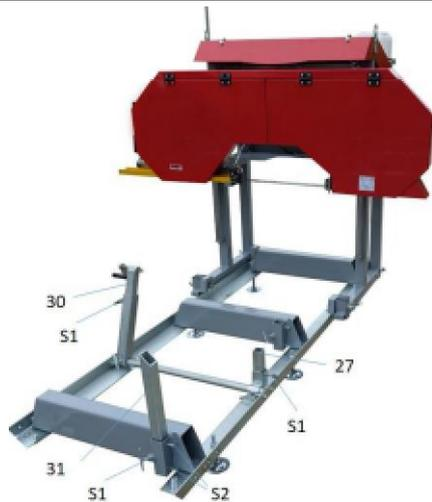
10. Ensamble las abrazaderas y topes: Coloque las abrazaderas (30) en sus soportes correspondientes y fíjelas con tornillos (S1). Inserte el tope largo (37) en el soporte de leños y fíjelo con tornillos. Inserte el tope corto (27) en el soporte y también fíjelo con tornillos (S1). La posición angular de los topes en el soporte de leños debe ajustarse utilizando dos tornillos (S2)
