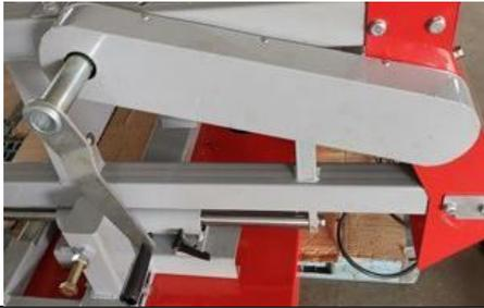
Ensamble la carcasa para la transmisión con cadena y ajústela a la placa con tornillos. Luego, coloque el mango.
