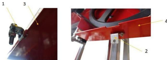
11. Ensamblaje del aparato asegurador para la hoja de aserradero: Fije el aparato asegurador (1) a la carcasa protectora (3) y ajústela con 2 tornillos y una tuerca superior. Fije el aparato asegurador (2) a la protección fija (3) de la hoja de aserradero y ajústela con 2 tornillos y una tuerca. Cierre la carcasa y realice los ajustes necesarios de posición (2) a (1) y ajuste los aparatos aseguradores. Pruebe ambos lados.
