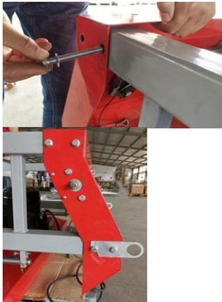
3.5 Ensamblaje de la carcasa: La carcasa y las dos asas para levantar se deben ajustar a los marcos izquierdo y derecho con tornillos, arandelas y tuercas.
